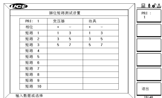
图 6-16 脚位短路测试设置页面
