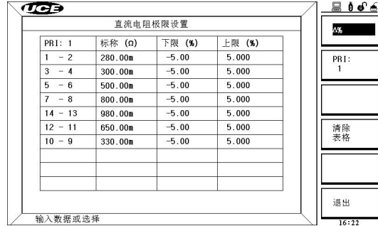
图 6-14 直流电阻极限设置页面
