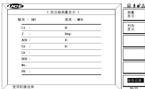
图 5-5 <变压器测量显示页面>
