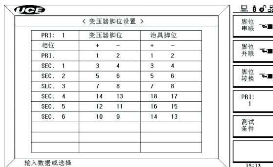
图 6-4 变压器脚位设置页面
